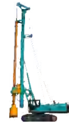
SWDM240H 最大扭矩:248kN.m 最大钻孔直径:2000mm 最大钻孔深度:69/54m
