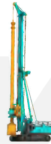
SWDM600 最大扭矩:600kN.m 最大钻孔直径:3500mm 最大钻孔深度:145/95m
