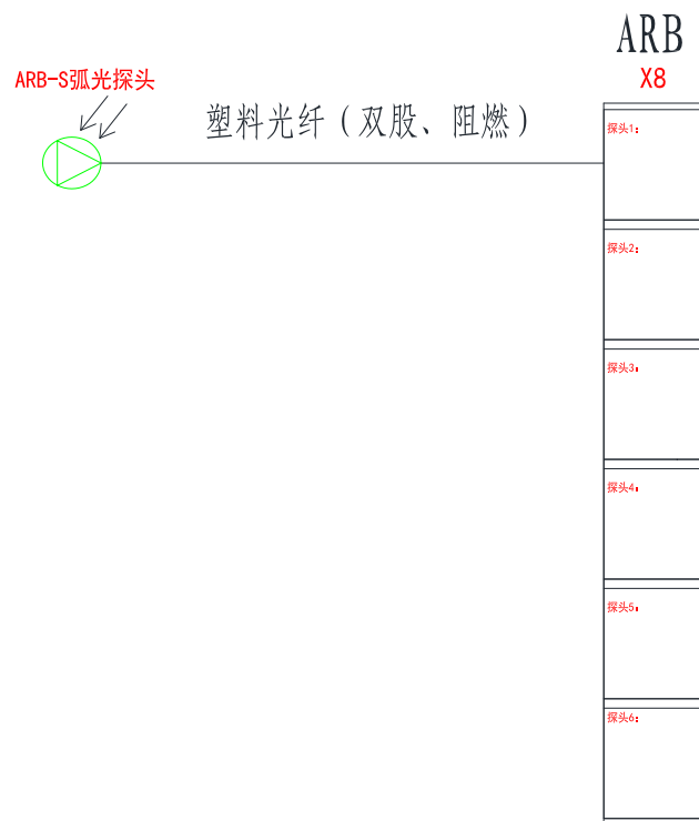
图 3.10 弧光采集接口光纤连接示意图
