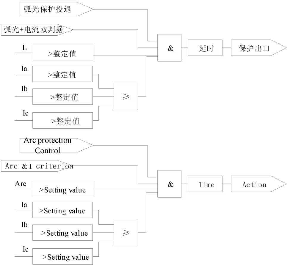
图1.2 弧光和电流双判据保护逻辑示意图
