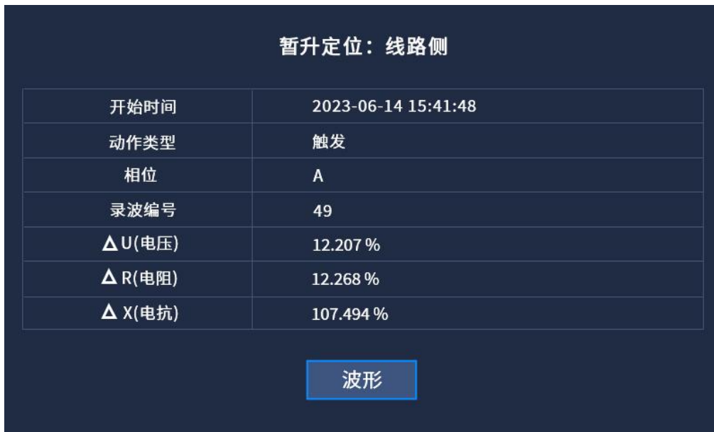
图 4.27(b) 电压暂升源定位-线路侧
