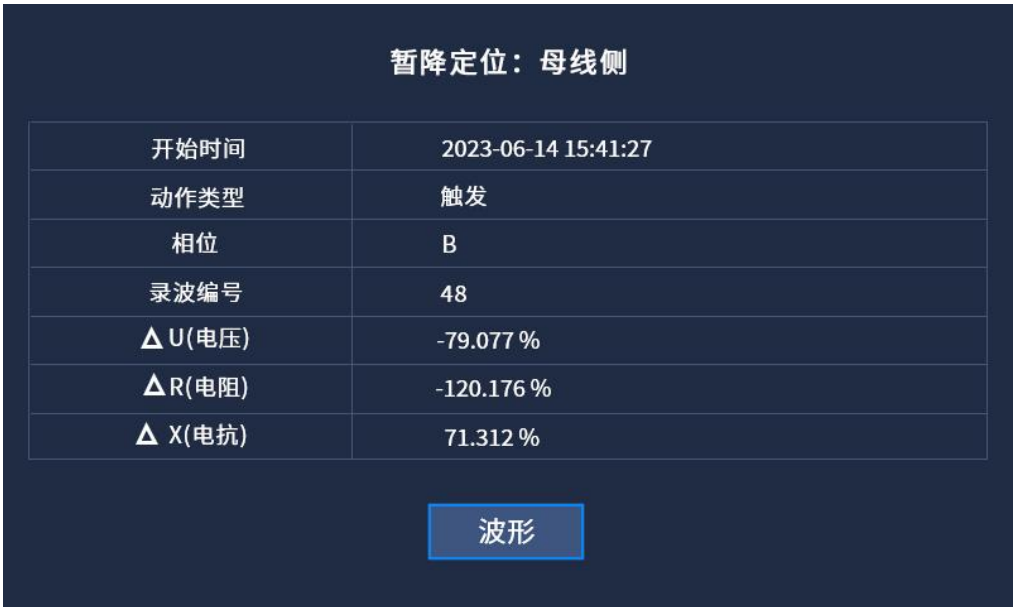
图 4.27(a) 电压暂降源定位-母线侧
