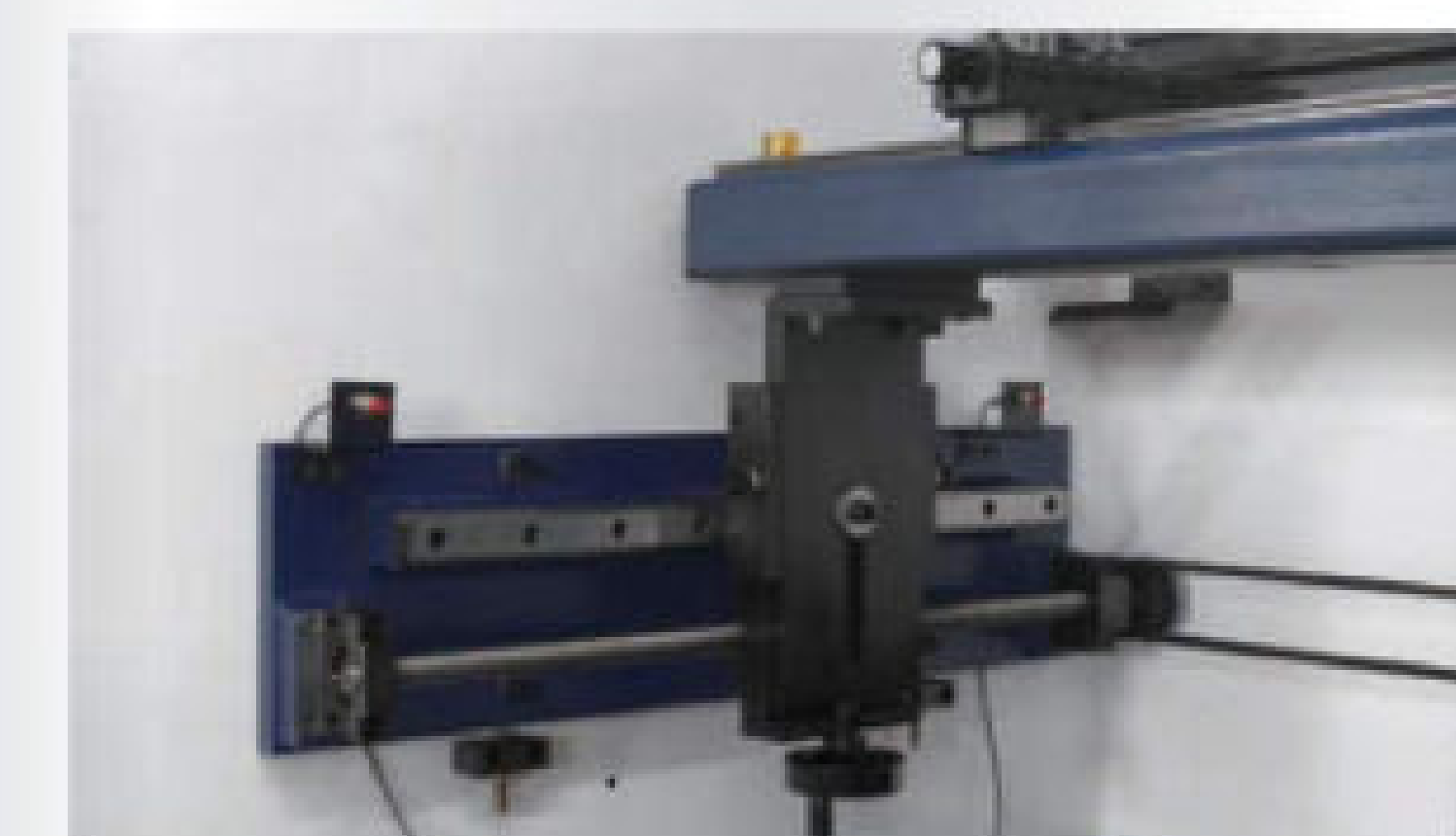
手动调节横梁高度 Manually adjust the beam height
