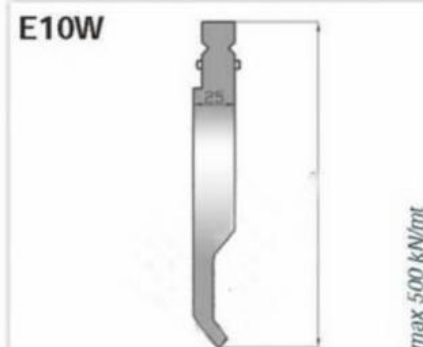
E10W USL 196/78° CW R1,0 altezza-height 196 mm angolo-degree 78° raggio-radius 1,0 mm 42CrMo4 rettificato-grinding temprato ind.-induction hardened HRC 52/58 lunghezze-lengths 508 mm - 500 / 550 fraz
