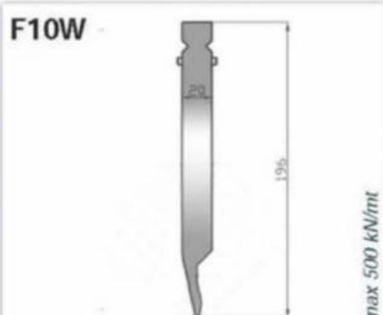
F10W USL 196/26° EW R1,0 altezza-height 196 mm angolo-degree 26° raggio-radius 1,0 mm 42CrMo4 rettificato-grinding temprato ind.-induction hardened HRC 52/58 lunghezze-lengths 508 mm - 500 / 550 fraz
