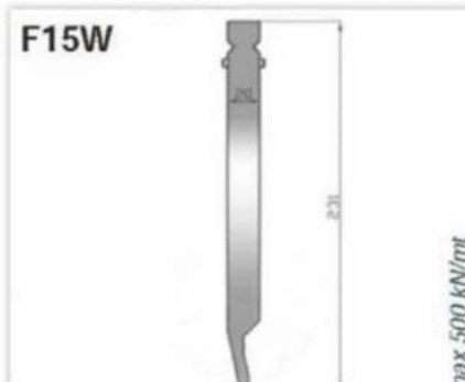
F15W USL 231/26° EW R2,0 altezza-height 231 mm angolo-degree 26° raggio-radius 2,0 mm 42CrMo4 rettificato-grinding temprato ind.-induction hardened HRC 52/58 lunghezze-lengths 508 mm - 500 / 550 fraz
