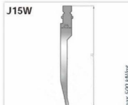
J15W USL 231/26° FW R2,0 altezza-height 231 mm angolo-degree 26° raggio-radius 2,0 mm 42CrMo4 rettificato-grinding temprato ind.-induction hardened HRC 52/58 lunghezze-lengths 508 mm - 500 / 550 fraz
