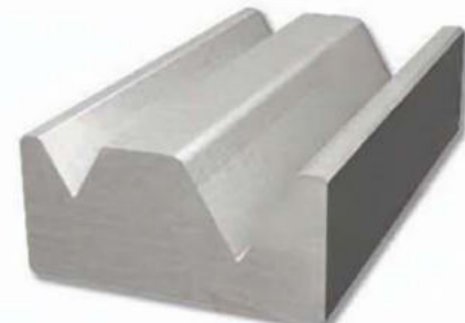
US 213/88° V 8 + 12 C45 rettificato-grinding temprato ind.-induction hardened HRC 52/58 lunghezza-lengths 835 mm - 415 mm
