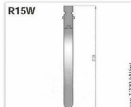
R15W USL 231/78° DW R3,0 altezza-height 231 mm angolo-degree 78° raggio-radius 3,0 mm 42CrMo4 rettificato-grinding temprato ind.-induction hardened HRC 52/58 lunghezze-lengths 508 mm - 500 / 550 fraz
