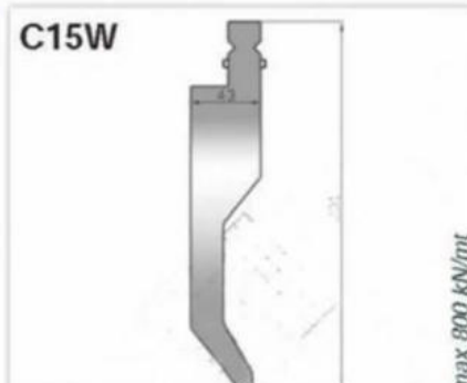
C15W USL 231/78° AW R2,0 altezza-height 231 mm angolo-degree 78° raggio-radius 2,0 mm 42CrMo4 rettificato-grinding temprato ind.-induction hardened HRC 52/58 lunghezze-lengths 508 mm - 500 / 550 fraz
