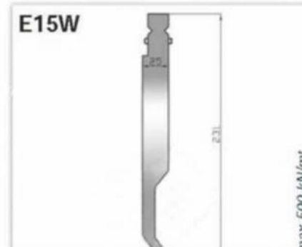
E15W USL 231/78° CW R2,0 altezza-height 231 mm angolo-degree 78° raggio-radius 2,0 mm 42CrMo4 rettificato-grinding temprato ind.-induction hardened HRC 52/58 lunghezze-lengths 508 mm - 500 / 550 fraz
