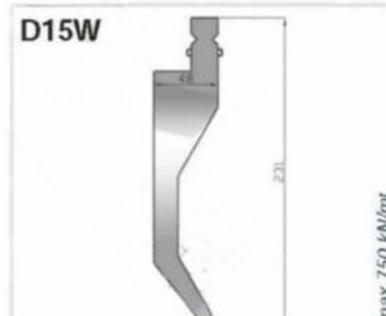
D15W USL 231/78° BW R2,0 altezza-height 231 mm angolo-degree 78° raggio-radius 2,0 mm 42CrMo4 rettificato-grinding temprato ind.-induction hardened HRC 52/58 lunghezze-lengths 508 mm - 500 / 550 fraz
